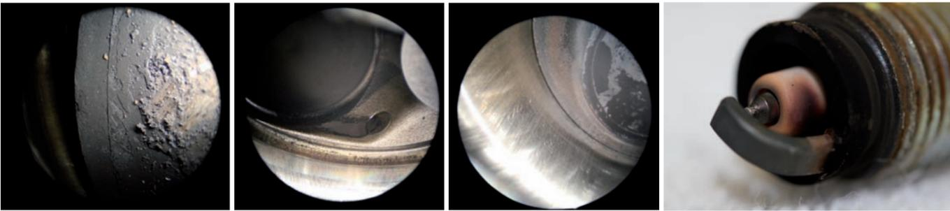
**VORHER (Betankung mit gewöhnlichem Super-Kraftstoff):** Keinesfalls rückstandsfrei: nach knapp 8000 km mit "gewöhnlichem" Super-Treibstoff zeigen sich bereits Ablagerungen im Motorinnenraum, auf dem Kolbenboden, Ventilen, Zylinderkopf und an der Zündkerze. Die Bilder wurden mit Hilfe eines Boroskops (auch bekannt als Endoskop) durch das Zündkerzenloch des Golf fotografiert.
